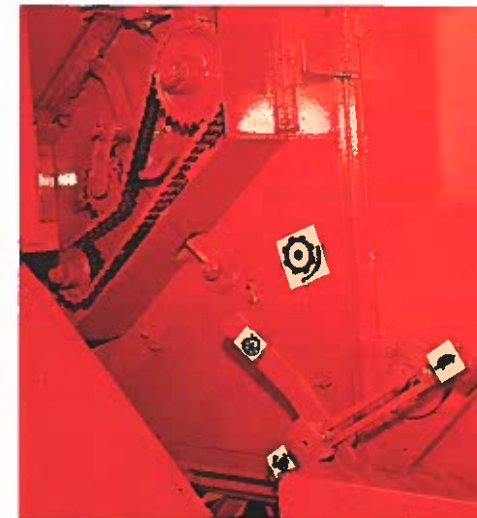
Trommelantrieb mit Duplexkette
