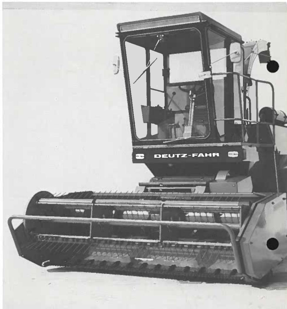
Doppelmessermähwerk zur Direkternte vom Halm
