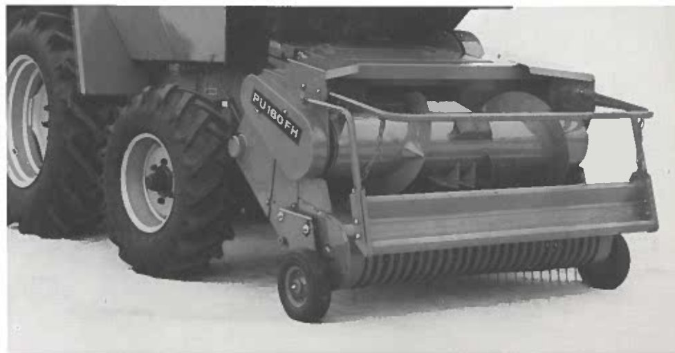
Doppelmessermähwerk zur Direkternte vom Halm
