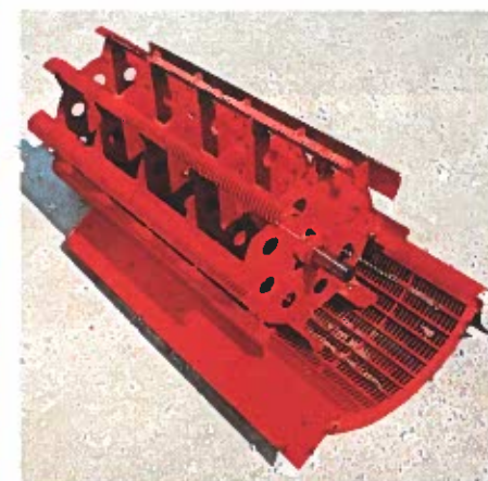
Großer Umschlingungswinkel der Trommel
