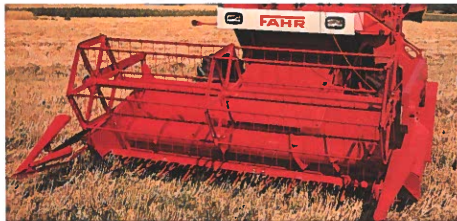
Die PU-Haspel erfaßt auch plattgewalztes Lagergetreide
