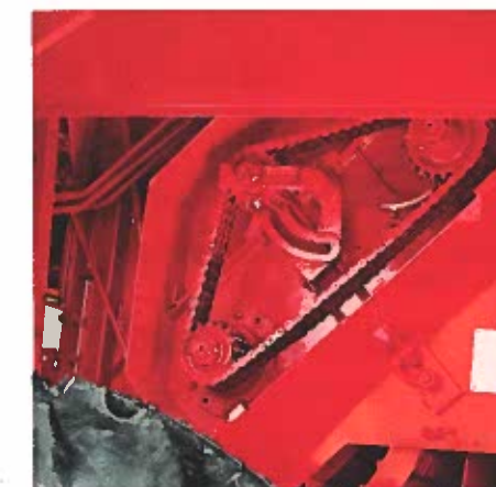
Trommelantrieb durch Triplexkette
