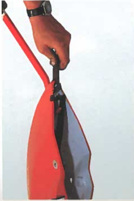
Patentierter Messerschnellwechsel. Mit einfachen Handgriffen – ohne zu schrauben – werden die Klingen gewechselt
