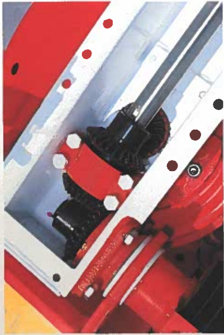
Gleason-Bogenverzahnung bietet unübertroffene Vorteile. Ruhiger Lauf, kein Verschleiß, leichtzünftig
