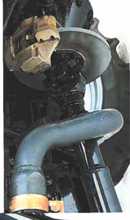
Hohe Bremsicherheit für Fahrer und INTRAC 2004: durch zusätzlich hydraulisch betätigte Scheibenbremse auf der Kardanwelle.
