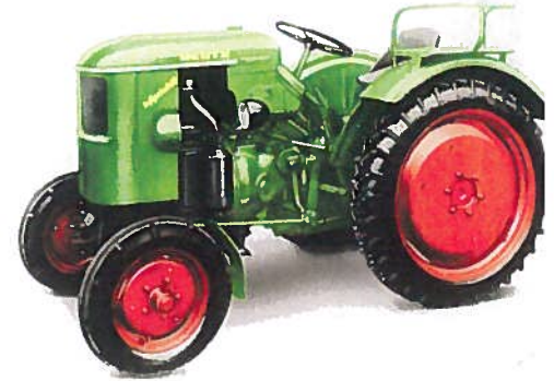
Il Deutz F1L 514 del 1949 il modello più piccolo della serie 514. È il primo trattore della Deutz sul quale è stato montato un propulsore diesel raffreddato ad aria, motore in grado di erogare su questa versione 15 CV.
