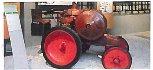
Il modello MTH 222 del 1927 è il primo trattore prodotto dalla Deutz. Equipaggiato con un propulsore orizzontale monocilindrico, aveva una potenza di 14 CV. Inizialmente concepito come motore semovente per le macchine da lavoro stazionarie, è stato prodotto in 330 esemplari.
