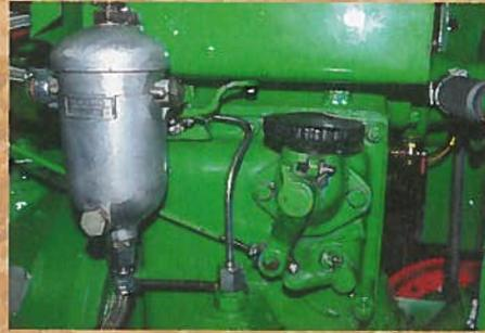
Einspritzpumpe und Kraftstofffilter wurden überholt und ersetzt. Auch die Leitungen sind neu und dicht – die Spritversorgung ist gesichert
