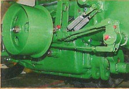
Neue Rückholfedern, die Übertragungsgestänge sehen aus, als liefe der Deutz direkt vom Band. Die Riemenscheibe treibt keine Geräte mehr an
