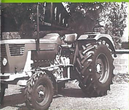
Deutztraktorema i 06-serien, som introducerades 1968, blev storsäljare. De fanns med 2-, 3-, 4- och 6-cylindriga luftkylda motorer på mellan 22 och 160 hästkrafter. Här är en D 7206 med en fyra på 70 hästkrafter.
