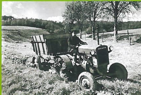
En Elfer-Deutz var precis vad bonden i mellankrigstidens Tyskland behövde. Den hade encylindrig, fyrtakts dieselmotor på elva hästkrafter. Den kunde fås med remskiva, fäste för slättermaskin, kraftuttag och gummihjul.
