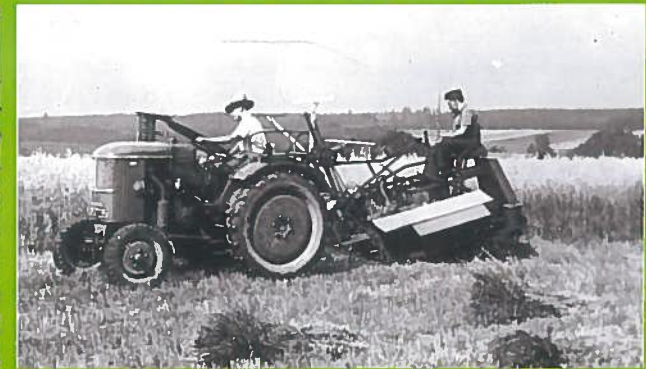
Deutz F1L 514 inledde den luftkylda eran hos Deutz. Den varade 1950–1992. Denna traktor hade en encylindrig motor på 1,33 liters volym som gav 15 hästkrafter vid 1 650 varv. Snart kom modeller med fler cylindrar.
