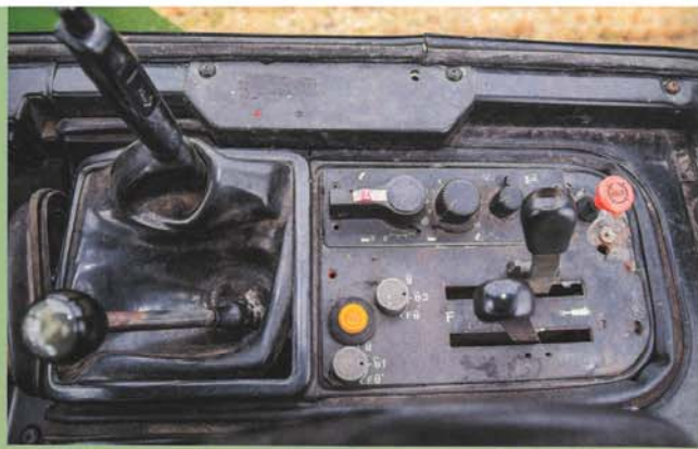
Die mechanisch-hydraulische Regelung, kurz MHR, wurde von den Kölnern bei der Serienausführung des Intrac durch eine elektrische (EHR) ersetzt – sie ist gut erreichbar rechts vom Fahrersitz positioniert
