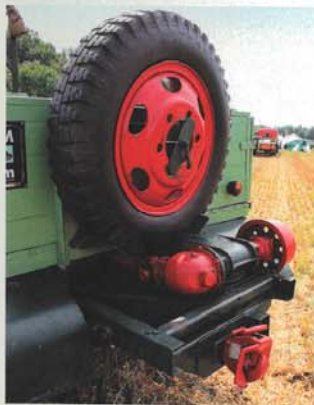
Das RS 1500-Heck ist gänzlich eigenständig – mit Ersatzrad, Riemenscheibe und unten angesetztem Spill als Seilwinden-Ersatz
