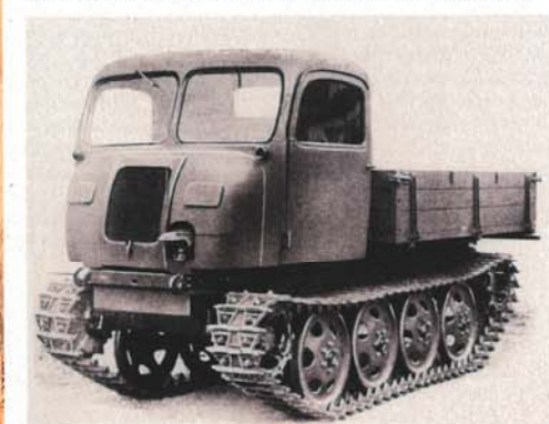
So sah der RSO in seiner Grundform aus. Das Ganzstahl-Fahrerhaus stammt mit kleinen Veränderungen vom Lastwagen Steyr 1500
