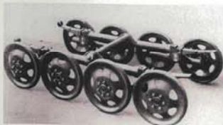
Chassis des Raupenschleppers Ost – mit den rohrförmigen Tragbalken samt Federn an den Enden und pendelnden Tragrad-Trägern
