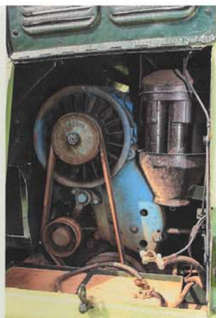
Der Deutz F4 L514 an seinem ersten richtigen Einsatzort: Im Waldschlepper geht es ziemlich eng zu, und man beachte den Luftfilter rechts
