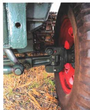
Die vorn pendelnd aufgehängte Traktorachse: Kennern werden sie dem F2 M417 zuordnen, der auch bei Magirus in Ulm gebaut wurde
