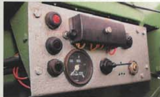
Die sparsamste Instrumententafel der Welt, die VDO-Öltemperaturanzeige ist nachgerüstet
