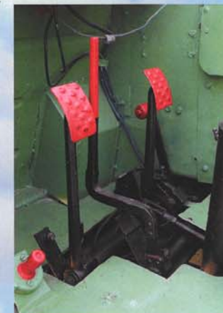
Waldschleppers Pedalerie: Der Hebel der Feststellbremse ist an das Gestänge der einstigen RSO-Lenkbremse angepasst
